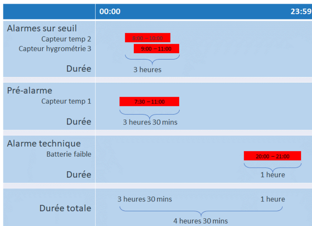
Figure 247 – Schéma représentant la durée des alarmes et des pré-alarmes
