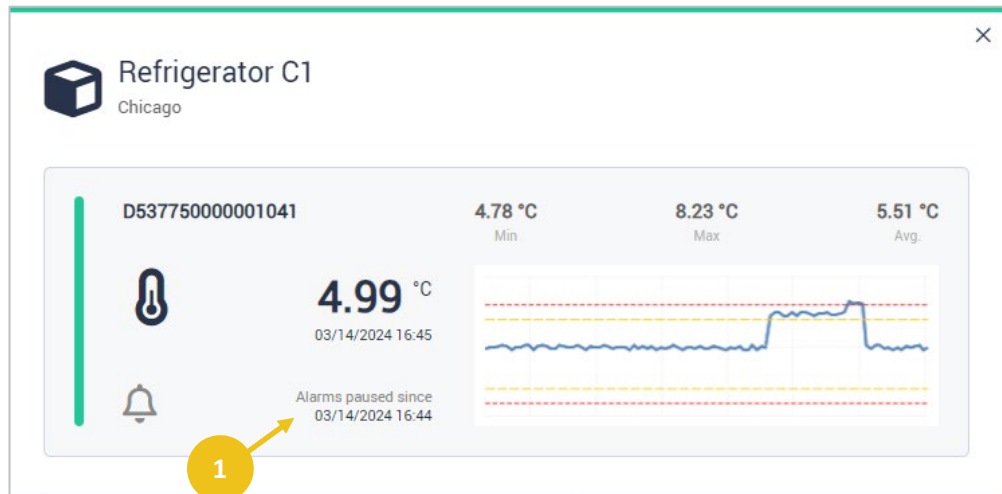
Abbildung 34 – Sensordetailansicht, die zeigt, dass Alarme auf dem Datenlogger angehalten wurden
