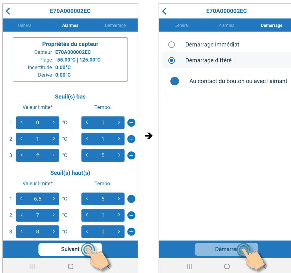
Démarrage de l'enregistrement avec des limites d'alarme haute et basse
